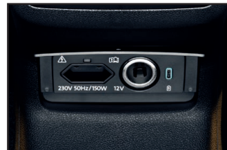
Gniazdo 230 V i USB typu C w tylnej części podłokietnika
